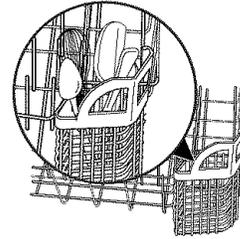
Le panier à ustensiles se suspend sur le panier inférieur dans le coin droit. Charger le panier à ustensiles pendant qu'il est sur le panier inférieur ou enlever le panier pour le charger sur un comptoir ou une table.
