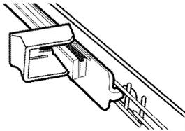
3. Placer les roulettes arrière du panier de chaque côté du panier dans la fente de la glissière et faire rouler le panier pour le réinstaller dans les glissières.
