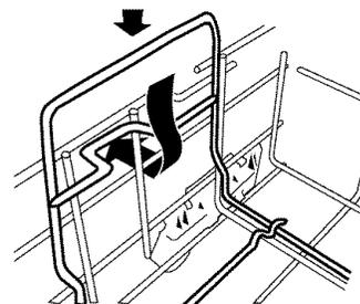
3. Lorsque l'onglet central sous la poignée s'enclenche sous la broche du panier sur le côté au milieu, l'insertion est en place. (Voir l'illustration.)
