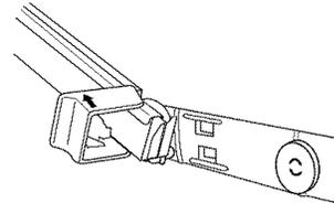
4. Insérer les roulettes avant du panier de chaque côté du panier dans les fentes de la glissière et faire glisser le panier pour le réintégrer partiellement dans le lave-vaisselle.
