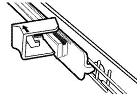
3. Placer les roulettes arrière du panier de chaque côté du panier pour ustensiles de cuisson dans les fentes de la glissière et faire rouler le panier pour le réinstaller dans les glissières.
