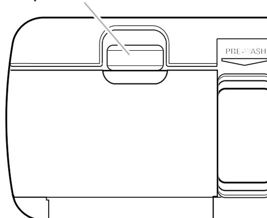
2. Remplir de détergent la section "Lavage Principal". La quantité de détergent nécessaire dépend de la quantité de résidus alimentaires sur la vaisselle et de la dureté de l'eau. Voir le tableau de dosage du détergent plus loin dans cette section.
