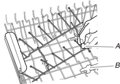
A. Soulever la broche de l'insertion amovible pour retirer les attaches de maintien
