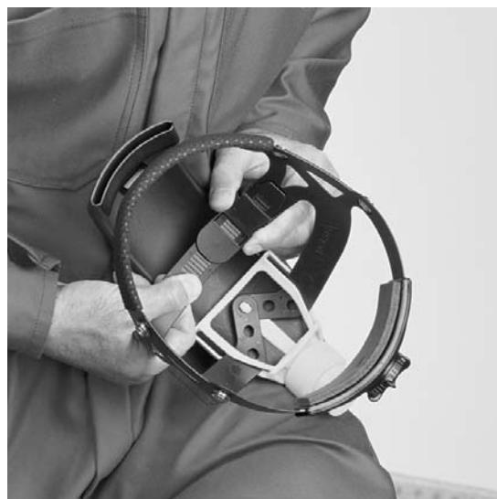
FIGURA 3 AGRANDE O DISMINUYA LA CORREA CENTRAL LATERAL
