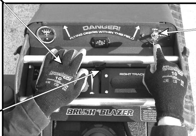
3. TURN THE KEY SWITCH TO THE RUN POSITION AND WAIT FOR THE FUEL PUMP TO ENGAGE. ONCE THE FUEL PUMP IS ENGAGED, TURN THE KEY TO THE START POSITION AND RELEASE
