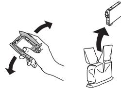
**Mise en garde :** Ne retirez aucune autre étiquette ni aucun ruban d'étanchéité, sinon l'encre risque de fuir. Ne touchez pas la puce verte sur le devant de la cartouche. Cela risque de l'endommager.
