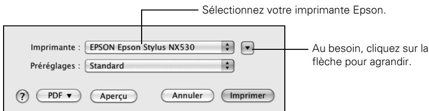
4. Sélectionnez les paramètres de copie et page de base. Pour l'impression de photos sans marges, sélectionnez un paramètre **Taille du papier** avec une option (**Sans marges**).
