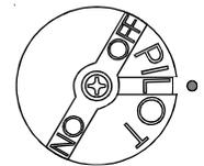
**COMPLETE (complet)** Pour complètement éteindre la machine, appuyez et tournez la commande de gaz dans le sens contraire à celui des aiguilles d'une montre jusqu'à "OFF" (arrêt). La friteuse est à présent complètement éteinte et peut être nettoyée et filtrée.
