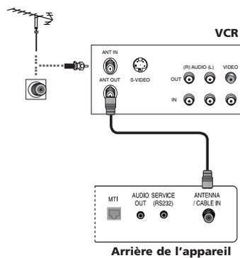
1. Branchez la sortie de l'antenne du magnétoscope à la prise d'entrée de l'antenne du téléviseur.
