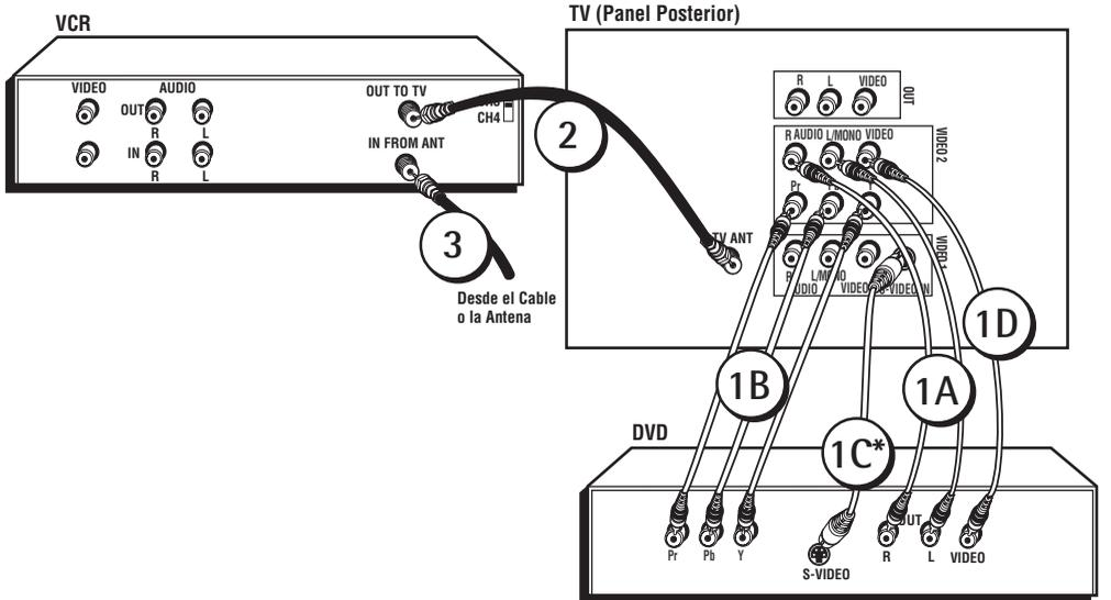
\* Si usted conecta un cable de S-Video, debe acoplar los cables de audio a los conectores VIDEO 1 AUDIO en la parte posterior del TV, no en los conectores VIDEO 2 AUDIO.
