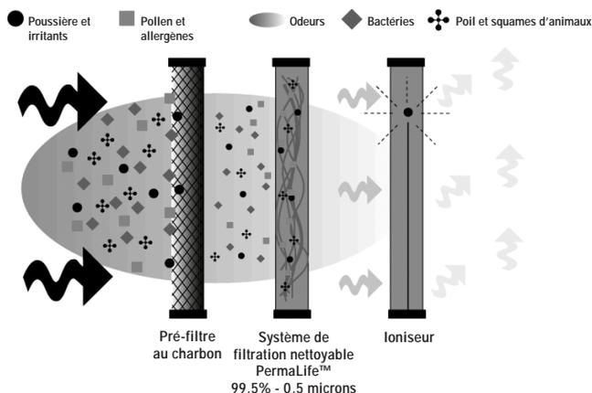
Fig. 1 - Illustration du système de filtration de l'air
