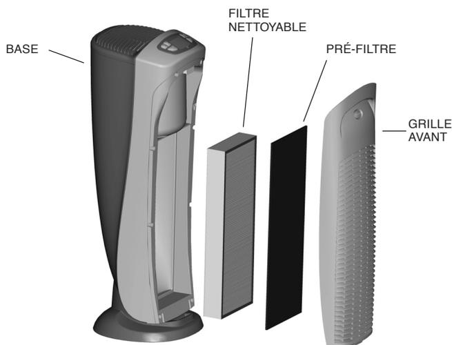
Fig. 2 - Composants du purificateur d'air
