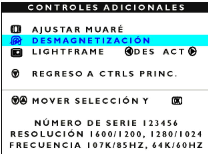
5) Para desmagnetizar la pantalla, pulse el botón
