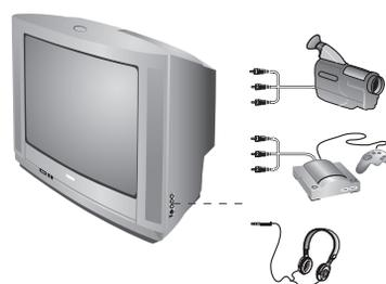
Selon les versions, les prises sont situées à l'avant (parfois sous un volet) ou sur le côté droit du téléviseur. Effectuez les raccordements ci-contre. Avec la touche **AV**, sélectionner AV. Pour un appareil monophonique, connectez le signal son sur l'entrée AUDIO L. Utilisez la touche **I-II** pour reproduire le son sur les haut-parleurs gauche et droit du téléviseur.
