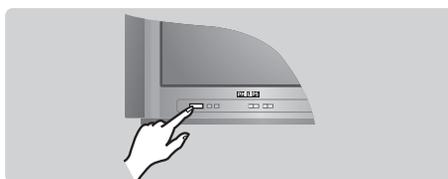
Нажать на клавишу вкл./выкл. для включения телевизора. Загорается красный световой индикатор, и экран загорается. Обратитесь непосредственно к главе быстрой установки на следующей странице. Если телевизор находится в дежурном состоянии, нажать на клавишу **P** (+) пульта дистанционного управления. При использовании пульта дистанционного управления световой индикатор мигает.
