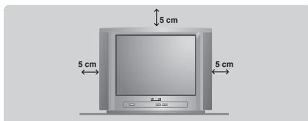
Установить телевизор на прочную и устойчивую поверхность, предусмотрев свободное пространство не менее 5 см вокруг телевизора. Не накрывать его (салфеткой, скатертью и т. п.), не ставить на него предметы, наполненные жидкостью (вазы) или выделяющие тепло (лампы), чтобы избежать опасностей или повреждений. Не допускать попадания брызгов воды на телевизор.
