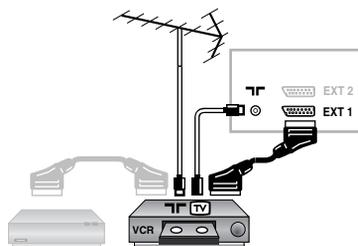
Осуществите указанные на рисунке подключения. Используйте шнур ПЕРИТЕЛЬ (SCART) хорошего качества. Если у вашего видеомагнитофона нет разъема перитель (или если этот разъем уже занят другой аппаратурой), то возможна лишь связь через кабель антенны.
