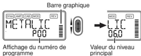
**note** Vous pouvez également effectuer des réglages de sorte que ▲/▼ CURSOR permettent de régler le volume principal (voir p.72 "Définition de la fonction d'encodeur rotatif").
