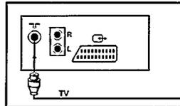
Wenn die TV Buchse benutzt wird, muß der Kanal unter einer Programmnummer gespeichert werden, ehe er gewählt werden kann (siehe den Abschnitt 'Speicherung des Videorecorderkanals unter einer Programmnummer').
