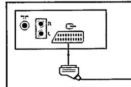
**Anmerkung:** Zur Erzielung eines optimalen Ton- und Bildsignals empfehlen wir, die Audio-/Video-Eingangsbuchse und die Euro-AV-Buchse nicht gleichzeitig zu benutzen.
