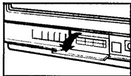
Die Tasten für die Wahl der Fernsehnorm und die Speicherung der Fernsehsender befinden sich unter der Klappe im Bedienungsfeld an der Vorderseite des Fernsehgeräts. Zur Bedienung der Tasten Klappe nach vorne ziehen. Nach Vornahme der gegebenenfalls erforderlichen Änderungen kann sie wieder geschlossen werden.
