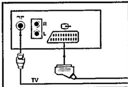
oder ein Gerät an die TV Buchse an der Rückseite des Fernsehgeräts angeschlossen werden.
