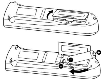
**Lorsque vous changez les piles, tentez de le faire en moins de trois minutes. Si l'opération de changement des piles dure plus de trois minutes, vous devrez peut-être réintroduire les codes de la télécommande pour votre magnétoscope, lecteur de DVD et/ou boîte de câble/ récepteur d'antenne parabolique. Reportez-vous aux pages 18 à 20.**
