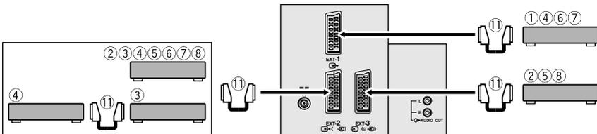
■ **Geräte, die das S-VIDEO-Signal (Y/C-Signal) z.B. von einem Videorekorder S-VHS ausgeben können**
