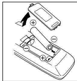
**OPMERKING:** Als u de afstandsbediening gedurende langere tijd niet gebruikt, haal de batterijen er dan uit. Anders kan de afstandsbediening door het lekken van de batterijen beschadigd raken.
