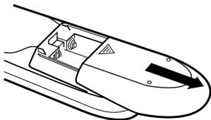
2. Insérez deux piles "AA" en observant leurs polarités, tel qu'indiqué sur le diagramme.
