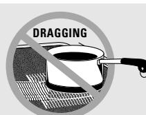
No deslice la olla o sartén a través del control o superficie de la cubierta ya que podría rayar el vidrio. El vidrio resiste las rayas, pero no es a prueba de rayas.
