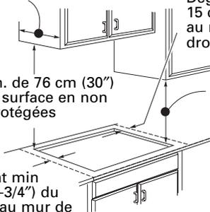
**REMARQUE :** tous les modèles de surface à cuisson au gaz requièrent un dégagement de 1,1 cm (7/16 po) sous la hauteur de la surface pour la matière combustible.
