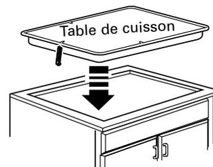
Une fois la table de cuisson en place, vissez les supports de fixation aux côtés de l'armoire pour tenir la table de cuisson bien en place.
