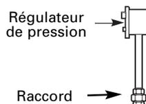
Pour réduire la possibilité de fuites de gaz, posez un ruban de téflon ou mettez de la graisse pour filetage approuvée pour le gaz naturel ou butane sur tous les raccords filetés.
