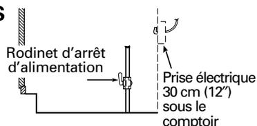
Montez le robinet d'alimentation manuel sur le tuyau de gaz à un emplacement facile à atteindre en dehors de la table de cuisson. Assurez-vous de savoir où et comment couper l'alimentation de gaz à la table de cuisson. Montez la prise électrique 30 cm (12") au-dessous du comptoir.
