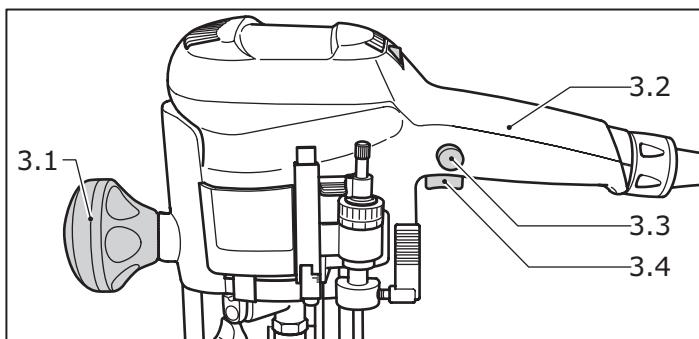
**ADVERTENCIA** La máquina tiene que ser sujetada siempre con ambas manos por la empuñadura (3.2) y por la empuñadura adicional (3.1) durante la conexión y el uso.
