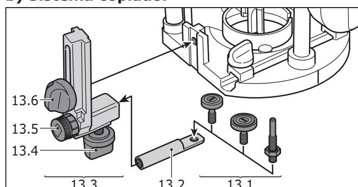
Para el sistema copiador se precisa el brazo angular WA-OF (13.3) y el set de copiar KT-OF, consistente en una sujeción de rodillo (13.2) y tres rodillos copiadores (13.1).
