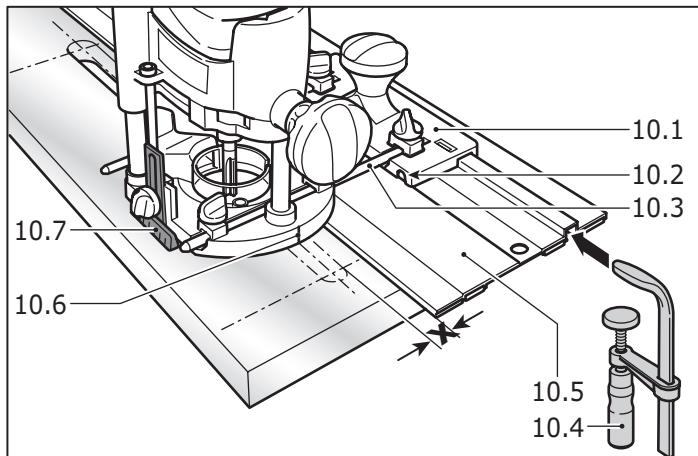
Le système de guidage FS (accessoire) facilite le fraisage de rainures droites.
