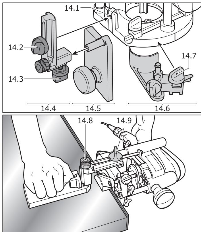
El brazo angular WA-OF (14.4), combinado con la placa guía UP-OF (14.5) (accesorios), permite fresar al ras los perfiles de encolado.
