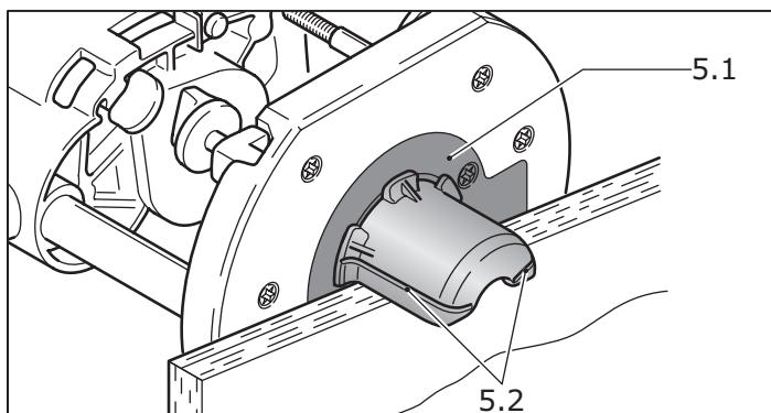
Mediante el colector de virutas KSF-OF (parcialmente en el suministro) se puede aumentar la efectividad de la aspiración al fresar cantos.
