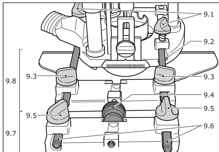
Para los trabajos paralelos al canto de la pieza se puede emplear el tope lateral (9.8) (accesorio) adjunto.
