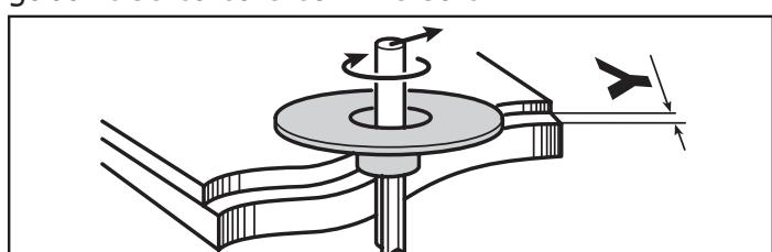
$$Y = \frac{1}{2} (\text{Ø de la bague de copiage} - \text{Ø de la fraise})$$
