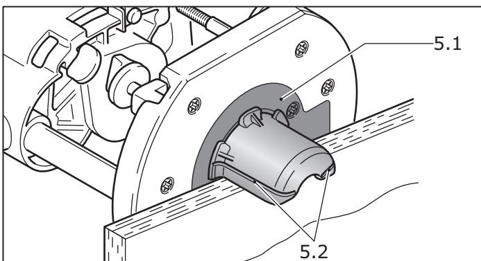
Le récupérateur de copeaux KSF-OF (en partie dans l'équipement standard) accroît l'efficacité du système d'aspiration lors des opérations d'affleurement.
