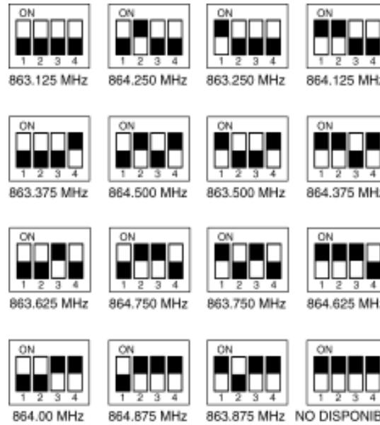
Ajuste microconmutadores en el receptor y en el transmisor llevado en el cinturón o en el micrófono de mano para las frecuencias correspondan. Los microconmutadores para el receptor se encuentran en el panel frontal. Los microconmutadores para el transmisor llevado en el cinturón se encuentran en el lado del conjunto de cinturón. Los microconmutadores para el micrófono manual son accesibles al abrir el portapilas en el lado del micrófono.
