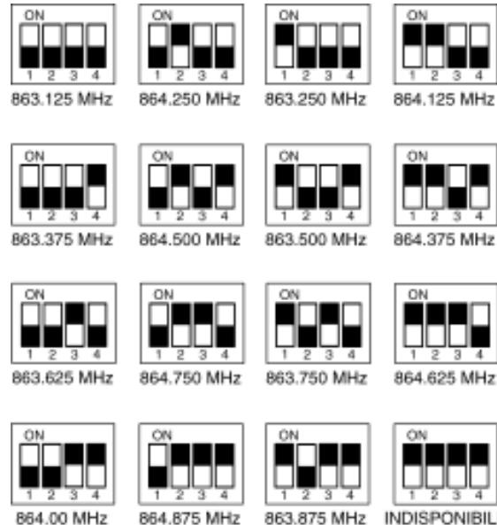
Orientare i dip switch del ricevitore e il trasmettitore palmare o a cintola sulla frequenza corrispondente. I dip switch del ricevitore sono situati sul pannello frontale. I dip switch del trasmettitore a cintola si trovano a lato di esso. I dip switch del radiomicrofono palmare sono all'interno del vano portabatterie a lato del microfono.
