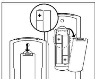
U heeft twee 1,5 V-batterijen nodig, type R03, UM4 of AAA. Plaats de batterijen als volgt.
