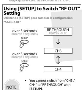
No podrá cambiar de "CH3 / CH4" a "TRAVÉS DE RF" con [SETUP].
