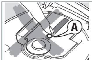
la lente puede empañarse si se traslada el equipo repentinamente de un ambiente frío a otro cálido. en ese caso, no es posible la reproducción. deje el equipo en un entorno cálido hasta que se evapore la humedad.
