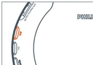
pulse esp repetidamente durante la reproducción para seleccionar entre:
