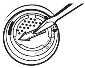
Tourner l'ajusteur à flèche à l'intérieur du distributeur soit à la main, soit en insérant un tournevis à lame plate au centre de la flèche et en tournant.
