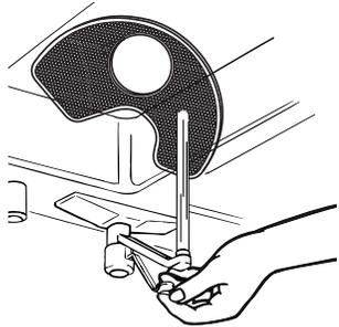
**IMPORTANT** : Ne pas utiliser de brosse métallique, de tampon à récurer, etc. car ils peuvent endommager les filtres. Pincer le filtre sous l'eau courante jusqu'à ce que la plupart des saletés soient éliminées. Si l'on remarque la présence de saletés difficiles à retirer ou de dépôts de calcaire causés par l'eau dure, l'emploi d'une brosse douce sera peut-être nécessaire.
