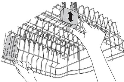
Il est possible d'élever ou d'abaisser le panier supérieur pour charger des grands articles dans le panier supérieur ou inférieur. Des réglages sont situés de chaque côté du panier supérieur. Élever le panier supérieur pour charger des articles d'une hauteur maximale de 9" (22 cm) dans le panier supérieur et de 13" (33 cm) dans le panier inférieur, ou abaisser le panier supérieur pour charger des articles d'une hauteur maximale de 1" (28 cm) dans les paniers supérieur et inférieur.
