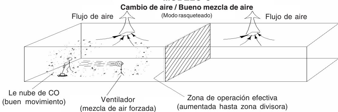
Observe la concentración de CO y la zona de operación efectiva (ampliada hasta la zona divisoria) con cambio de aire y mezcla de aire forzada. La nube de CO sigue concentrada de un lado de la zona divisoria. Observe la “zona divisora” que se muestra arriba, éste es el lugar donde el flujo de aire cambia de dirección. En el Modelo 3, los cambios de aire se reducen a la mitad ya que prácticamente nada de CO cruza la zona divisoria para ser extraído.
