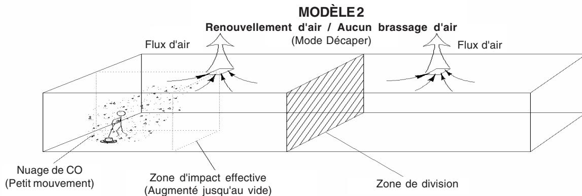
Veuillez observer la concentration en CO et la zone d'impact effective avec le renouvellement d'air. Le nuage de CO est encore concentré en une zone réduite. Veuillez noter la "zone de division" présentées ci-dessus, il s'agit de la ligne au niveau de laquelle le flux d'air change de direction. Dans le modèle 2, les changements d'air sont divisés en deux puisque peu ou pas de CO ne traverse la zone de division pour être déchargé.
