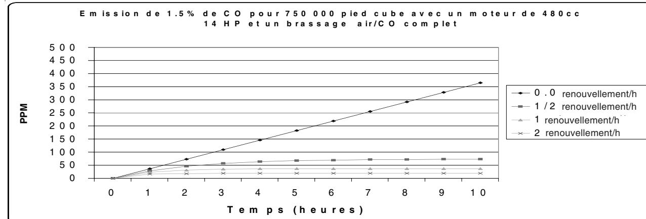
**Le graphique ci-dessus présente la relation renouvellement d'air/temps et le CO en ppm avec la zone en pied par mètre cube et le pourcentage d'émissions de CO demeurant constant.**
