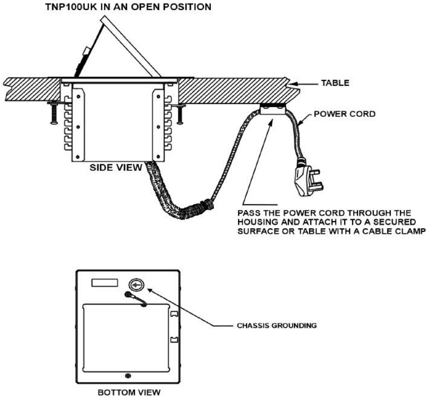
NOTE: THE DIAGRAM OF THE SIDE VIEW ABOVE SHOWS ONLY THE POWER CORD NOT THE CABLES
