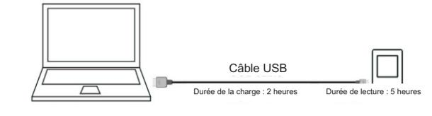
La pile de ce porte-clés avec cadre photo numérique se charge par le biais du câble USB. Pour ce faire, il suffit de brancher le câble USB sur la prise USB de votre ordinateur et sur le porte-clés lui-même. Il faut compter environ deux heures pour que la pile du porte-clés se charge entièrement. Une pleine charge de la pile du porte-clés avec cadre photo numérique vous permet de profiter de 5 heures de visionnement de photos.
