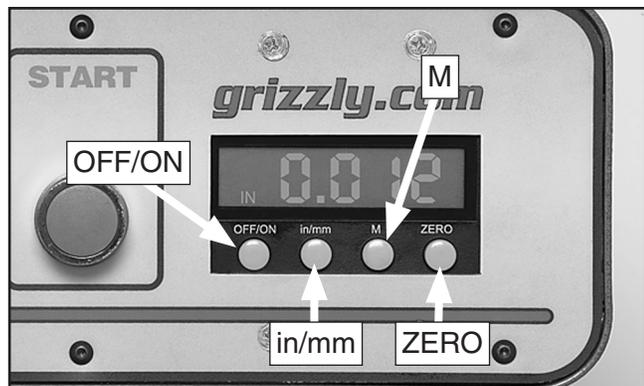
Figure 25. Digital readout.
