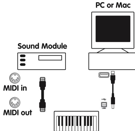
Bei aktiviertem "MIDI Out from USB"-Modus (siehe Abschnitt 4.1) werden die vom Computer an Axiom gesendeten Daten direkt zum MIDI-Ausgang von Axiom und von dort aus zum externen Soundmodul geroutet. Damit funktioniert Axiom als USB-MIDI-Interface. Zuvor müssen Sie allerdings Axiom in Ihrer Sequenzer-Software als MIDI-Ausgabegerät auswählen.
