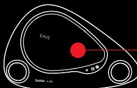
Drücken Sie die EA VS Woofer-Abdeckung an der Oberseite des tragbaren Lautsprechersystems zur Entriegelung und zum Einschalten des Lautsprechersystems nach unten. Das Lautsprechersystem funktioniert nur beim geöffneter Abdeckung.
