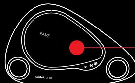
En la parte superior del sistema de altavoces portátil presione el recinto del reforzador de bajos EAVS para liberarlo y encienda el sistema de altavoces. El sistema de altavoces no funcionará hasta que esté abierto el recinto del reforzador de bajos.
