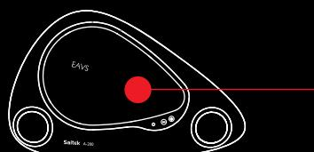
Appuyez sur la partie mobile du système EAVS qui se trouve sur le dessus de l'appareil. Ceci aura pour effet d'ouvrir la chambre d'expansion et d'activer le système. Le système d'enceinte ne fonctionnera pas tant que la chambre de basse ne sera pas activée.
