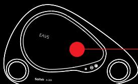
Sopra il sistema di altoparlanti portatile premere la cassa woofer EAVS per rilasciarla e per accendere il sistema di altoparlanti. Il sistema di altoparlanti non funziona fino a quando non si apre la cassa woofer.
