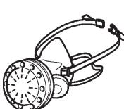
Pour réduire les risques d'exposition à ces substances chimiques : travaillez dans un endroit adéquatement ventilé et utilisez un équipement de sécurité approuvé, tel que masques antipoussières spécialement conçus pour filtrer les particules microscopiques.
