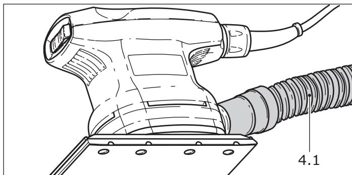
A fin de evitar un frecuente cambio del turbofiltro durante trabajos de lijado relativamente largos, en lugar del dispositivo autoaspirador se puede conectar un aspirador Festool. Para ello se cala el tubo flexible de aspiración ( $\varnothing$  27 mm (4.1)) del aspirador sobre la tubuladura de aspiración.
