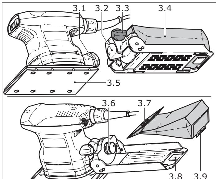
Les machines sont équipées en série d'un dispositif d'auto-aspiration. La poussière de ponçage est aspirée à travers les orifices d'aspiration du patin de ponçage (3.5) puis collectée dans le filtre turbo (3.4). Lorsque le filtre turbo est rempli de poussières, la performance d'aspiration baisse et il faut le remplacer.
