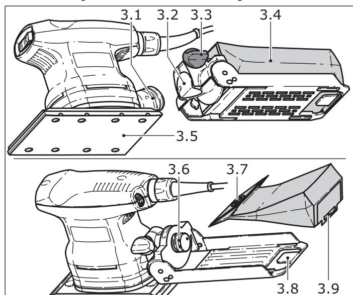
Las máquinas están equipadas como equipo de serie con un dispositivo autoaspirador. El polvo de lijado es aspirado por las aberturas de aspiración que se encuentran en el plato de lijado (3.5) y es recogido en el turbofiltro (3.4). Cuando el turbofiltro se ha llenado hasta el punto de que se nota una merma de la capacidad de aspiración, se deberá proceder a su cambio.
