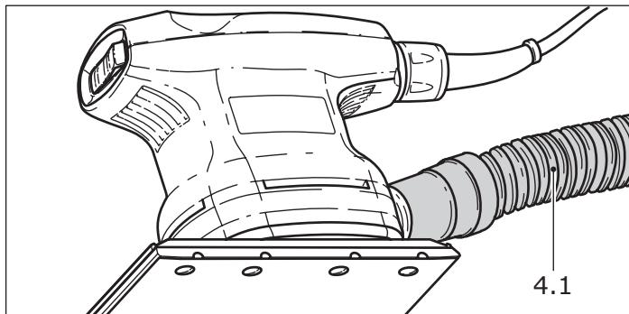
Afin d'éviter d'avoir à remplacer souvent le filtre turbo, on peut raccorder un aspirateur Festool à la place du dispositif d'auto-aspiration. Pour ce faire, le flexible d'aspiration ( $\varnothing$  27 mm (4.1)) de l'aspirateur est monté sur le manchon d'aspiration.
