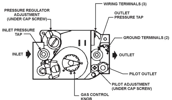
**HONEYWELL GAS VALVE FOR I.I.D. SYSTEM (TOP VIEW)
