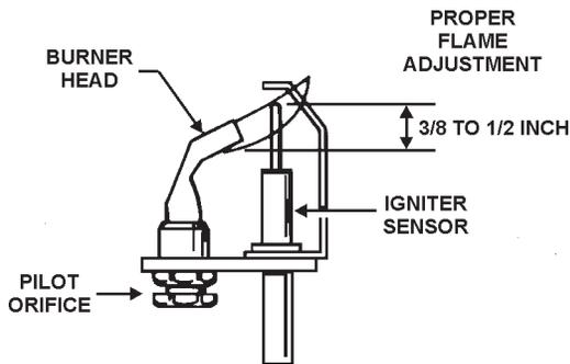
**PILOT BURNER USED ON I.I.D. SYSTEMS
