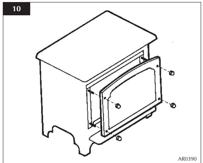
**NEVER OPERATE THE STOVE WHEN THE DOOR IS REMOVED.**
